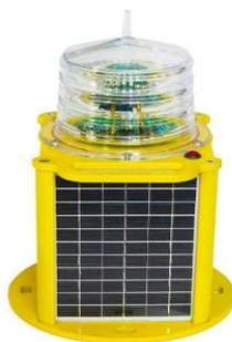
Lanterna compacta de Sinalização Náutica, lâmpadas de Led (Branca, Verde, Amarela, Encarnada: **conforme necessidade**) com alcance de 10 Milhas Náuticas, autossustentáveis com painéis solares e bateria, contidas em seu próprio corpo, providas de iluminação através de LED na cor branca. Célular fotoelétrica e 256 códigos de lampejos pré-programados. **Marca: Annhung Modelo: AH-LS/C-10**
