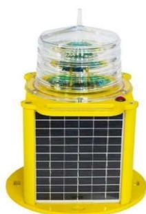
Lanterna Compacta de Sinalização Náutica, lâmpadas de LED (Branca, Verde, Amarela, Encarnada **conforme necessidade**) com alcance de **5 Milhas Náuticas**, autossustentáveis com painéis solares e bateria contidas em seu próprio corpo, providas de iluminação de LED. Células fotoelétricas e 256 códigos de lampejos pré-programados. **Marca: Annhung Modelo: AH-LS/C-6**
