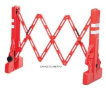
Cavalete retrátil, portátil, fabricado em polietileno de alta resistência, com inibidor UV-A e B, formado por 2 bases ocas. Dotado de tampa rosqueável para regulagem de peso por água ou areia e unidas por sistema pantográfico composto por 6 réguas plásticas. Possui travas de segurança para maior estabilidade do produto e alça para transporte. A reflexibilidade do cavalete feita por 4 tiras retrorefletivas de micro prisma branco.
