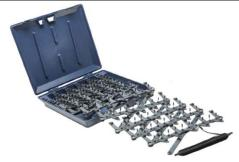
O Bloqueador de Fuga Eloo e um dispositivo de esvaziamento de pneus usado para parar veículos em alta velocidade em perseguições ou fiscalizações de tráfego. Cada sistema é constituído por agulhas ocas de aço inoxidável montado numa resistente e reutilizável base pantográfica. O sistema possui um cordão de nylon 10 metros, para o manuseio da grade principal. O Bloqueador vem acondicionado em uma maleta compacta rígida para seu transporte. O kit tem 30 agulhas extras e um trocador de
